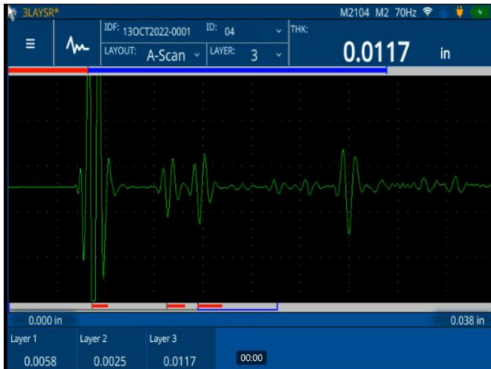
Medição de 50 MHz de um recipiente de plástico com três camadas realizada no medidor de espessura ultrassônico 72DL PLUS
